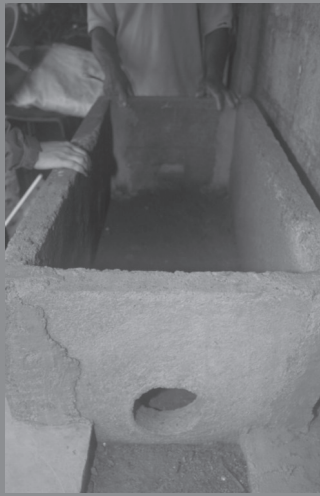
Molde de Cemento, montado
